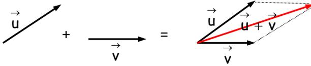
En este caso es equivalente la **regla de la poligonal**, la cual consiste en disponer vectores equipolentes a los dados de forma tal que el origen de uno de ellos coincida con el extremo del otro. La resultante es el vector que tiene por origen el origen del primer vector y por extremo el extremo del segundo vector.
